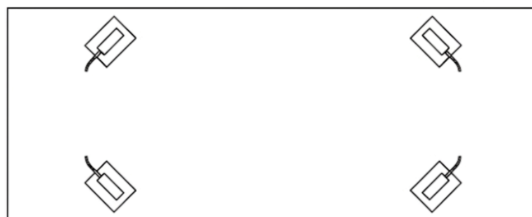
Figuur 8 – aanbevolen opstelling van loadcellen voor silo's, tanks en mixers
